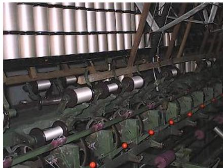
Gambar 66. Mesin perangkap benang
